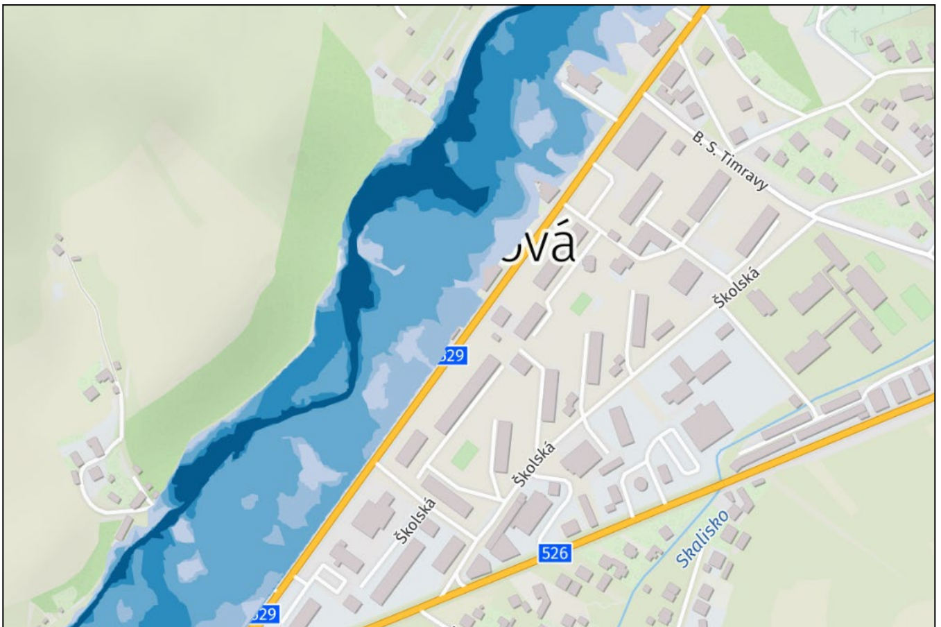
Obr. 4-11 Teleso cesty ako líniová stavba s potenciálom ochrany územie pred povodňami
