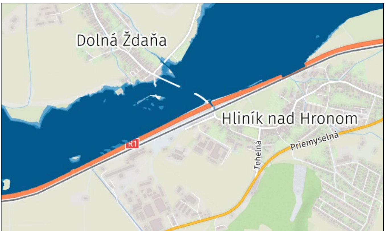
Obr. 4-12 Teleso cesty ako líniová stavba s potenciálom ochrany územie pred povodňami
